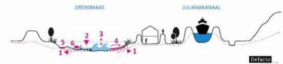
Figuur 2 De belangrijkste ontwikkelingen van de Maas die problemen veroorzaken bij hoge rivierafvoeren respectievelijk geringe rivierafvoeren.
